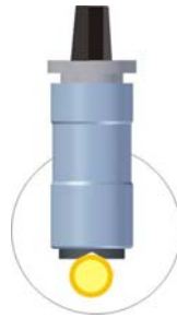
Bild. 1-1 optimale Verbindung zwischen Messkopf und zu messendem Kabel
