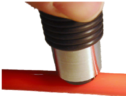
Bild 2: Das Kabel muss durch Messung an 3 bis 5 verschiedenen Stellen gemessen werden.
